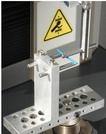
Abbildung 1: Rohrprobe während der E-Modul Messung
